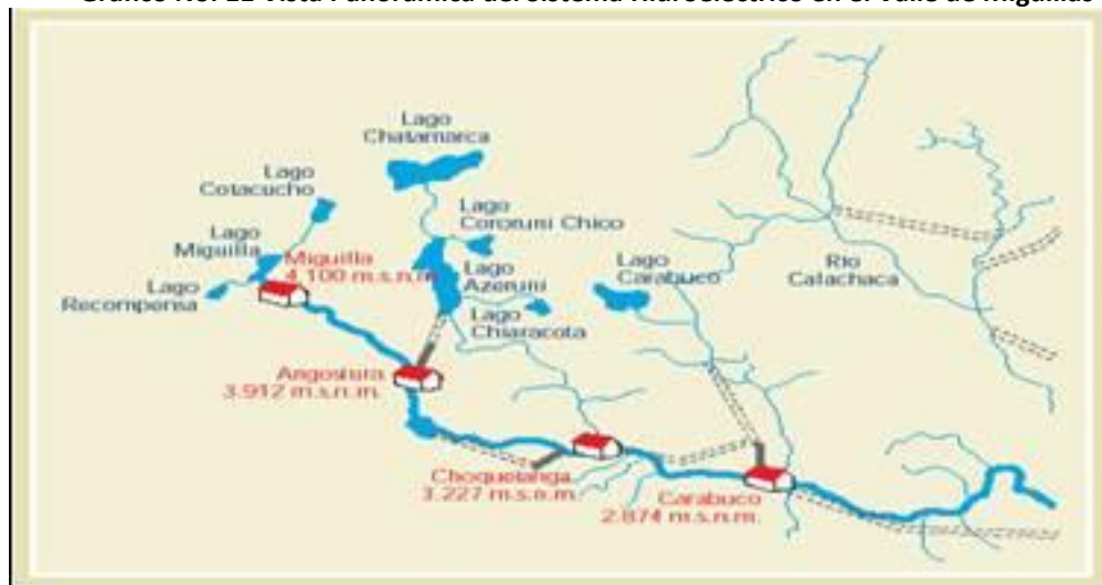
Gráfico No. 11 Vista Panorámica del Sistema Hidroeléctrico en el Valle de Miguillas
